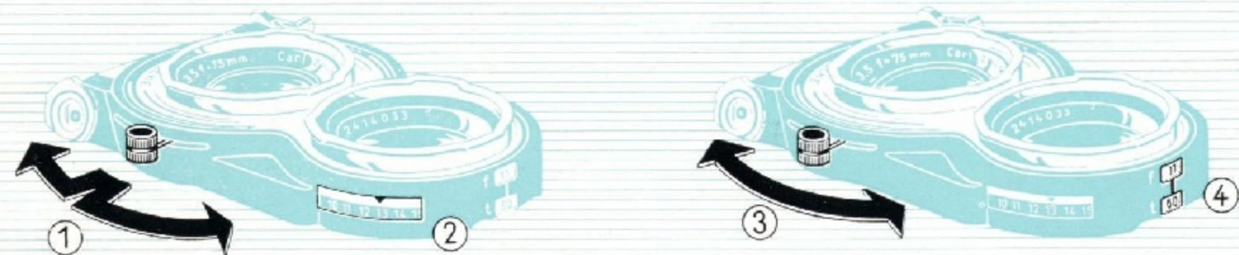
Le levier ① assure le couplage automatique du temps de pose et du diaphragme: en tirant sur le levier, on débraye les échelles, en le lâchant, on les embraye de nouveau.
