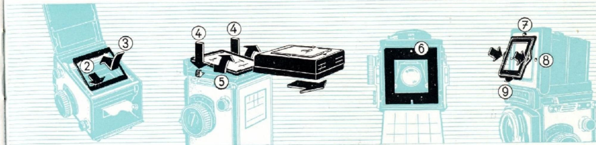
**Mettre en place le cache de film:** Introduire le cache par le bord à ressort — d'abord en bas ② et ensuite en haut derrière le cadre de film ③. — Enlèvement: pousser le cache vers le bas et le retirer.
