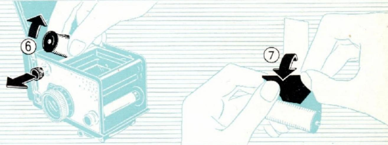
Après la dernière vue, enrouler le film jusqu'à ce que la marque de fin d'exposition ⊙ apparaisse dans le compteur d'image. Le film est alors entièrement enroulé sur la bobine réceptrice, la manivelle reste déverrouillée.
